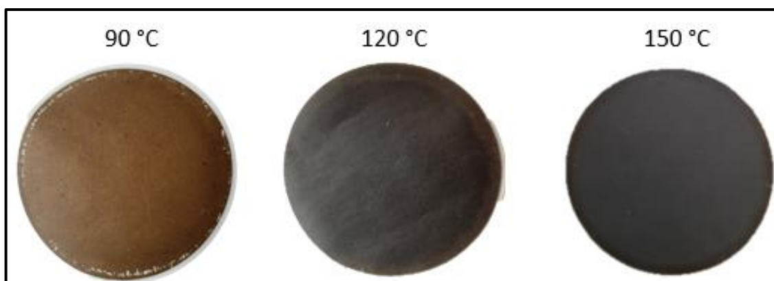
Figura 14. Imagens das membranas modificadas secas à 90, 120 e 150 °C pós ciclos de dessalinização.
